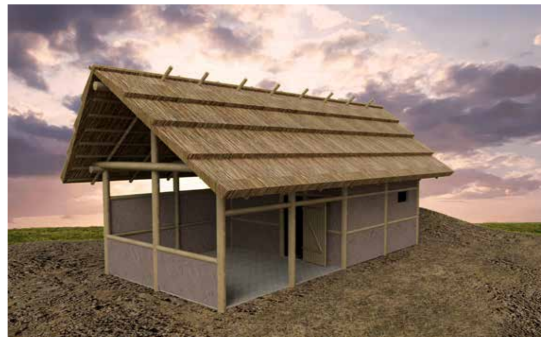
Stavby kůlové konstrukce s proplétanými stěnami s hliněnou omazávkou. Funkce řemeslných dílen - kovolictví, keramika, proutěná a textilní řemesla.
